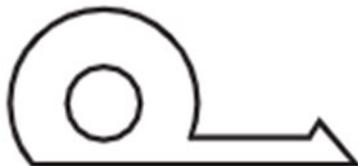
2. EMT, Pneumatiques à Mobilité Etendue (Extended Mobility Tyres) sont des pneumatiques radiaux, agréés comme tels, conformément au Règlement UN 30, et qui sont identifiés par le symbole spécifique ci-dessous, marqué sur leur flanc.
