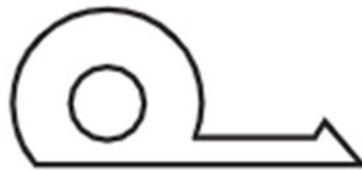
2. EMT (Extended Mobility Tyres) sind Radialreifen, die als solche gemäß UN-Regelung 30 zugelassen sind und durch das unten angegebene spezifische Symbol auf der Seitenwand gekennzeichnet sind.
