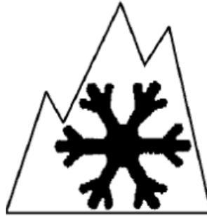
Minimum 15 mm Basis und 15 mm Höhe, in der Nähe der M+S Kennzeichnung. Die obige Zeichnung entspricht nicht den korrekten Massen.
